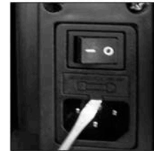
Abbildung 4: Lösen Sie die Hülse mit einem Flachschaubenzieher heraus.
