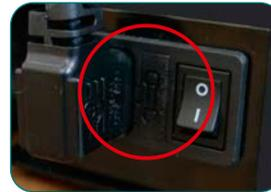
Ziehen Sie die Gerätekupplung aus dem Sessel. Zwischen An-/Aus-Schalter und Gerätestecker befindet sich mittig die Hülse der Hauptsicherung.
