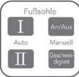
Hinzu- bzw. Ausschalten (29) der Fußsohlenmassage. Zur Auswahl stehen die Automatikabfolgen I und II (31) sowie die manuelle Einstellung (30), bei der sich die Geschwindigkeit der Fußsohlenmassage in 3 Stufen variieren lässt.
