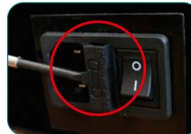
Lösen Sie die Hülse der Hauptsicherung vorsichtig mit einem Flachschaubenzieher und ziehen Sie diese heraus.
