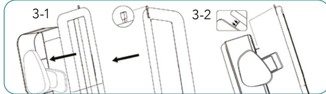
**Schritt 3:** Auflagematte befestigen und Heizkabel verbinden
